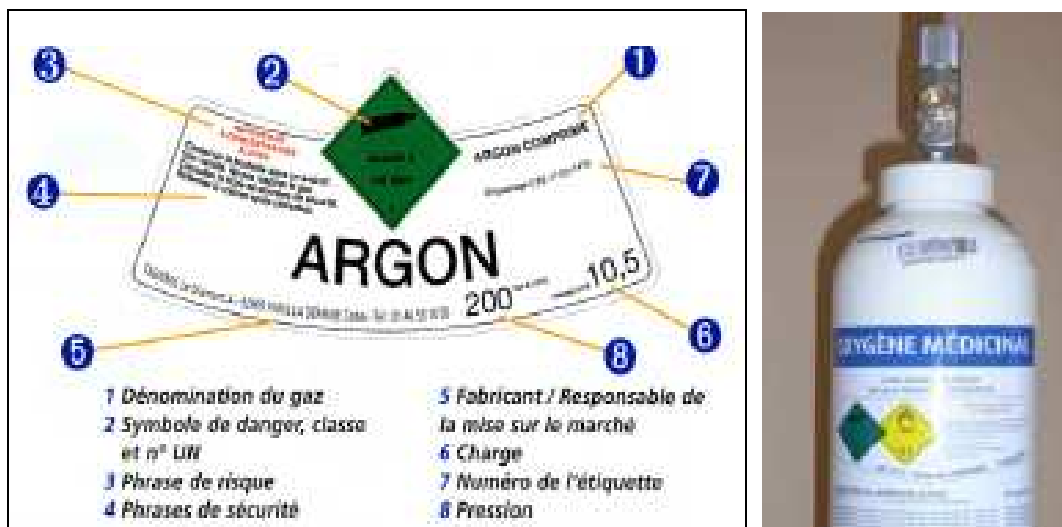
Figure 6. Étiquettes ADR (cas de l'argon et de l'oxygène)
